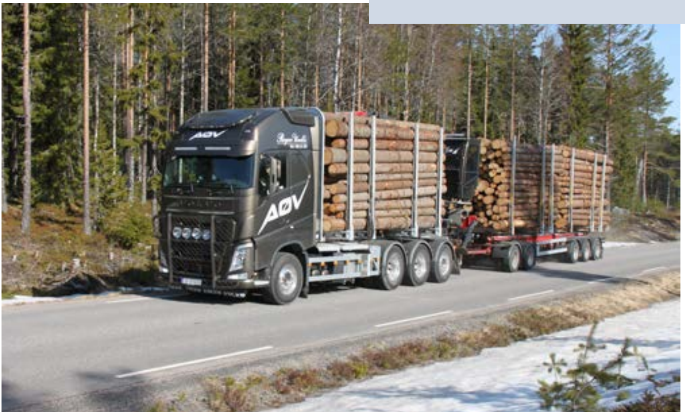
FIGUR 17 Niakslede vogntog med 74 tonn totalvekt vil gjøre biltransporten mer effektiv
