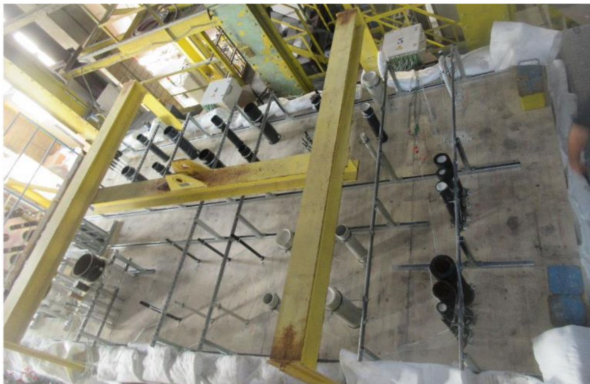
Test av massivt tre element (3m x 6m) med tekniske gjennomføringer branttettet med Protecta produkter.
