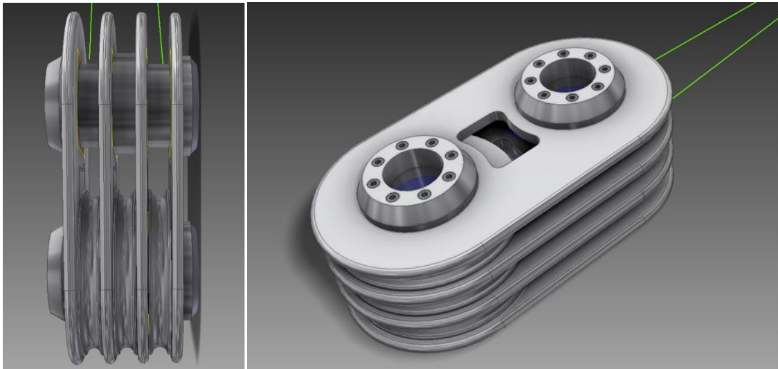
Figur 3: En fiberslynge er festet i toppen (grønn linje) og seks tau fordeler kreftene mellom de tre skivene i blokka. Aluminiumsblokka er en mer kompakt konstruksjon enn standardblokka.
