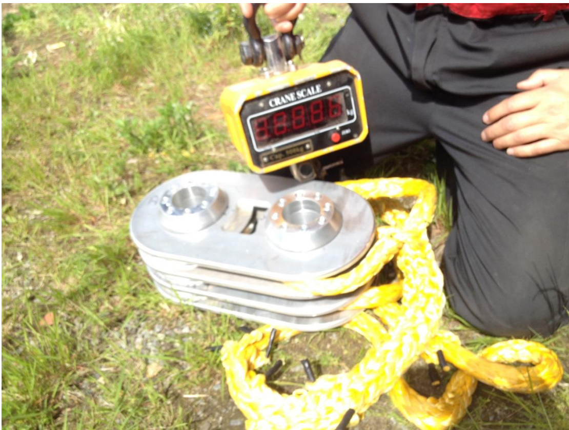
Figur 1 Ny type fordelingsblokk i aluminium med fibertauslynge 19,5 kg.
