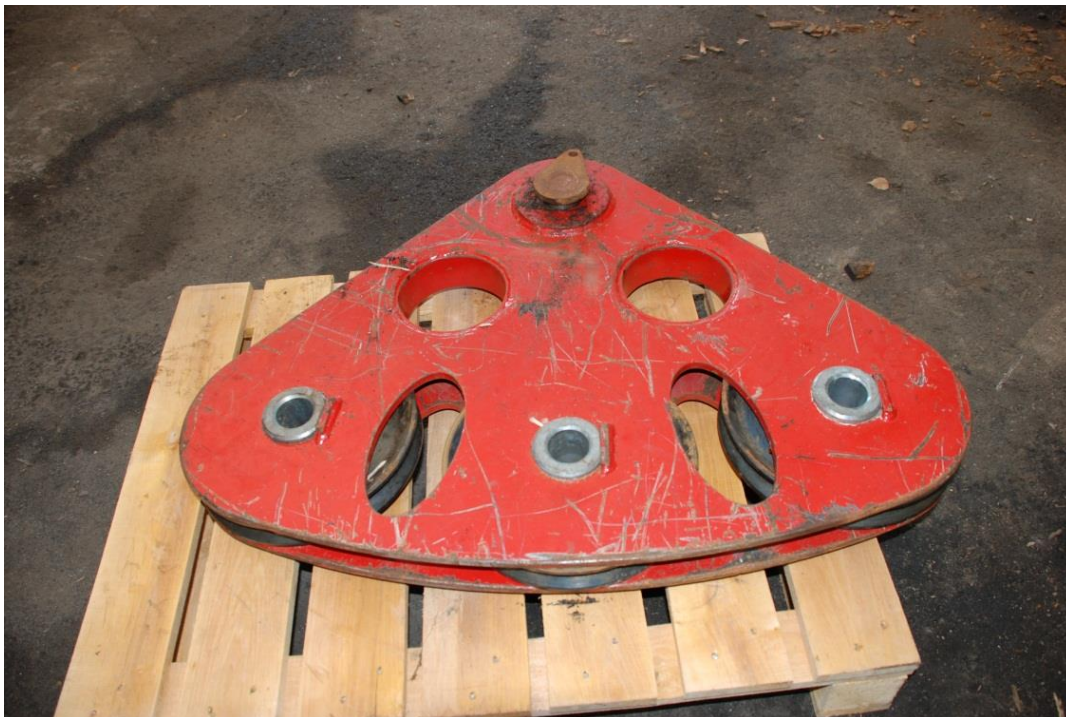
Figur 2: Standard fordelingsblokk i stål, 72 kg. Denne fordeler kreftene fra bærekabelen gjennom flere barduner til fester i terrenget.
